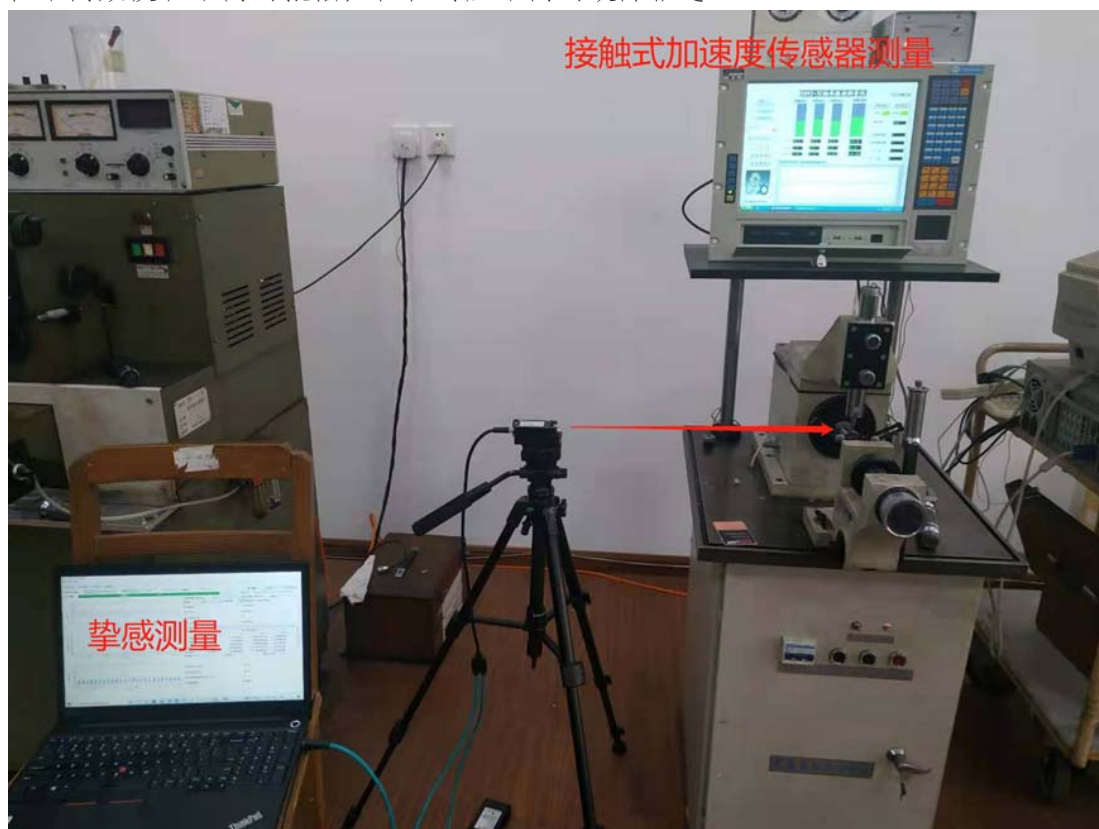
图 1 挚感光子激光测振仪与接触式轴承振动测量仪对比测试
