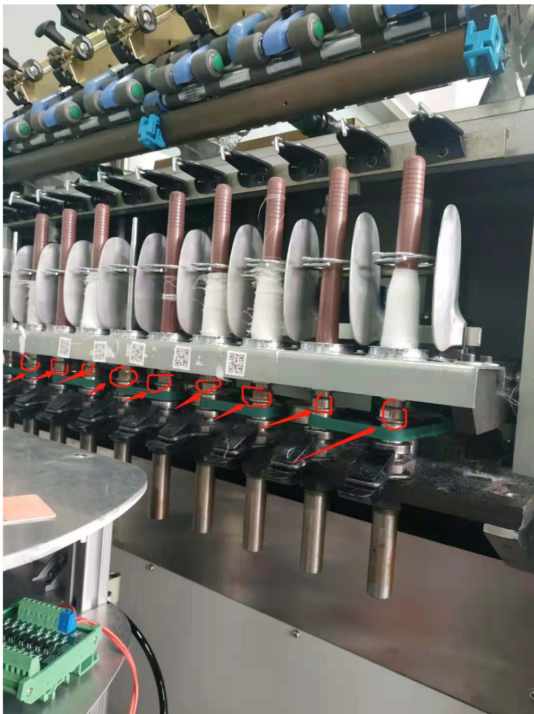
图2 纺织机旋转锭子轴测振动检测
